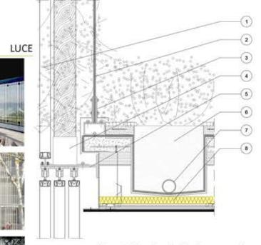
1 Parapetto in lamelle verticali di cedro rosso canadese 2 Parapetto in vetro stratificato 3 Supporto in acciaio zincato 4 Bicchiere in acciaio zincato sez. 130x130 mm 5 Staffa di supporto del sistema oscurante in acciaio zincato, sp. 5 mm 6 Fioriera in acciaio zincato dim. 40x40x120 cm impermeabilizzata dall'interno
