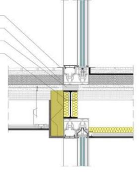
8 Scossalina in alluminio, sp. 2mm 9 Pavimentazione esterna 10 Dima in legno sez. 120x90mm 11 Isolante morbido in lana minerale sp. 40mm
